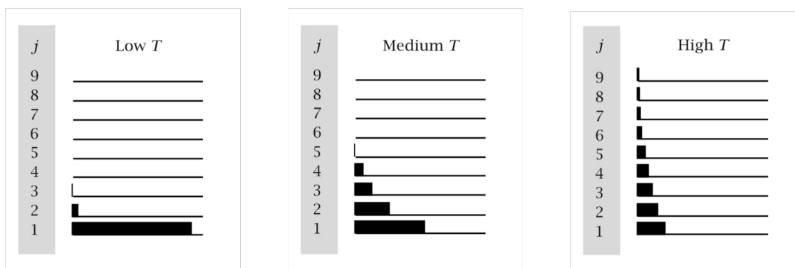
Figura 1: População relativa \exp(-\varepsilon_i/kT) de níveis energéticos em três temperaturas diferentes. Note que quanto mais energético o nível, menor tenderá a ser sua população. À medida que aumentamos a temperatura, entretanto, os níveis de energia mais elevados se tornam mais acessíveis e se tornam mais ocupados.
