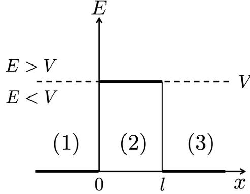
Figura 3: Sistema com barreira de potencial retangular
